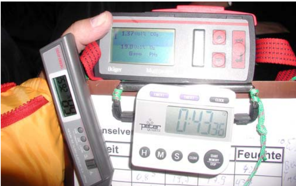
Abb. 3: Messgeräte für Gase und Klima in einer Marine-Rettungsinsel
